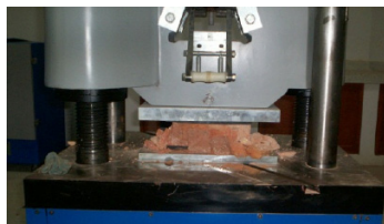
Figura 1 Ensayo de compresión en ladrillos
