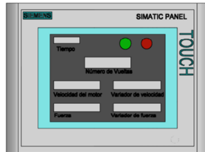
Figura 9. Control Principal HMI del banco de pruebas de fatiga.
